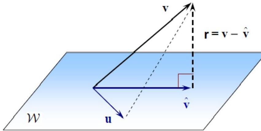
Figura:  $v$  é um vetor do  $\mathbb{R}^3$ . O plano  $\mathcal{W}$  é um sub-espaco vetorial de dimensão 2. dado um vetor  $u$  do sub-espaco,  $\|v - u\|$  (linha tracejada fina) é o comprimento do vetor  $v - u$ .
