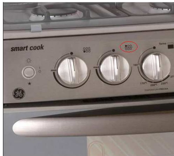
Figura 2-7 mapeamento registro x queimador em um fogão
