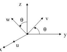
$$R_{x,\theta} = \begin{bmatrix} i_x \cdot i_u & i_x \cdot i_v & i_x \cdot i_w \\ i_y \cdot i_u & i_y \cdot i_v & i_y \cdot i_w \\ i_z \cdot i_u & i_z \cdot i_v & i_z \cdot i_w \end{bmatrix}$$
