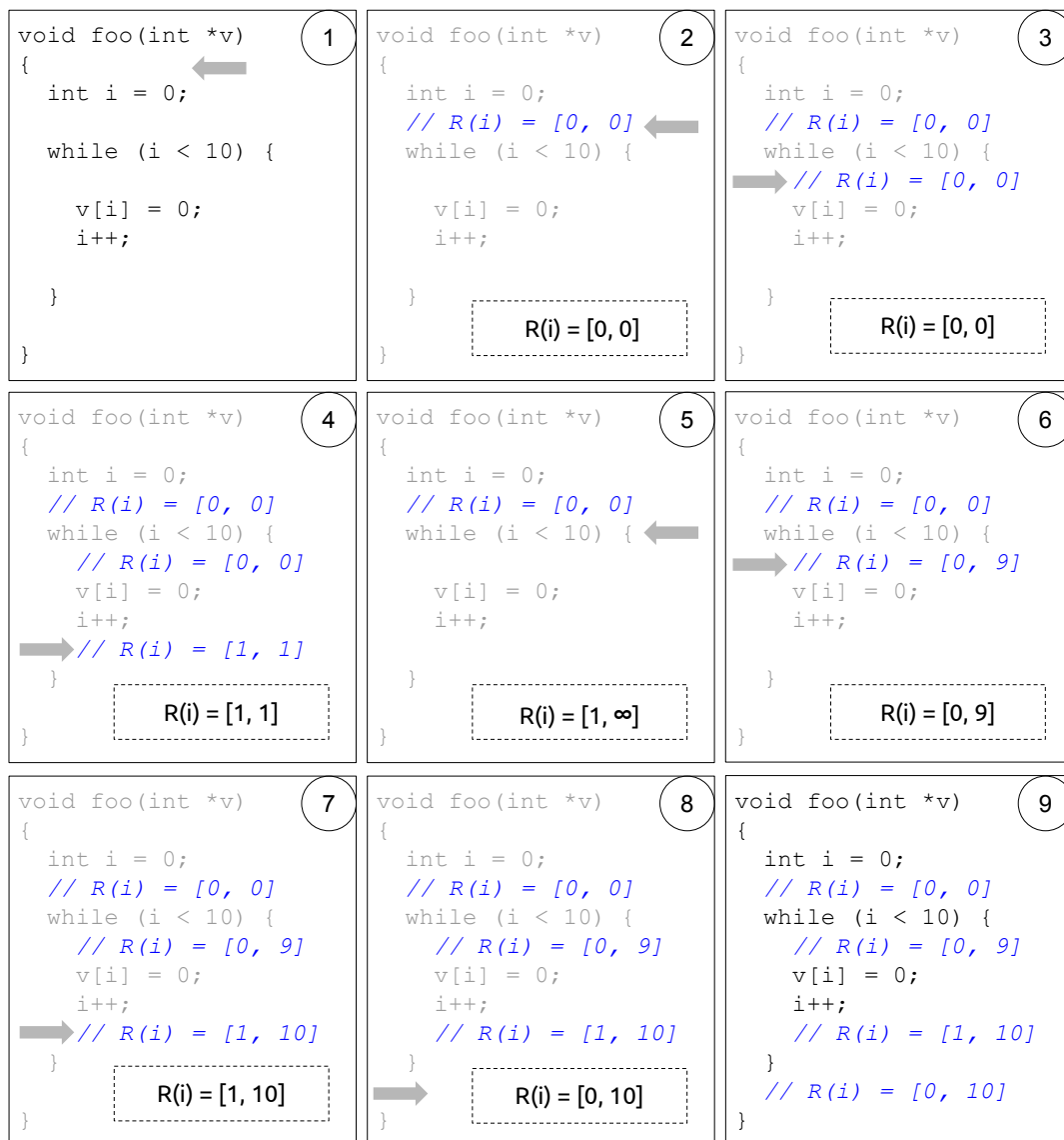
Figura 4.3: Esquema com exemplo de como acontecem as operações de widening e narrowing .
