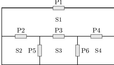
Determine o número mínimo de novas portas a instalar de forma que uma pessoa possa, ao chegar na construção, passar por cada porta exatamente uma vez e sair para o exterior. Justifique modelando o problema por meio de grafo. Em que locais devem ser instaladas as novas portas (se o número mínimo de novas portas for maior que zero)?
