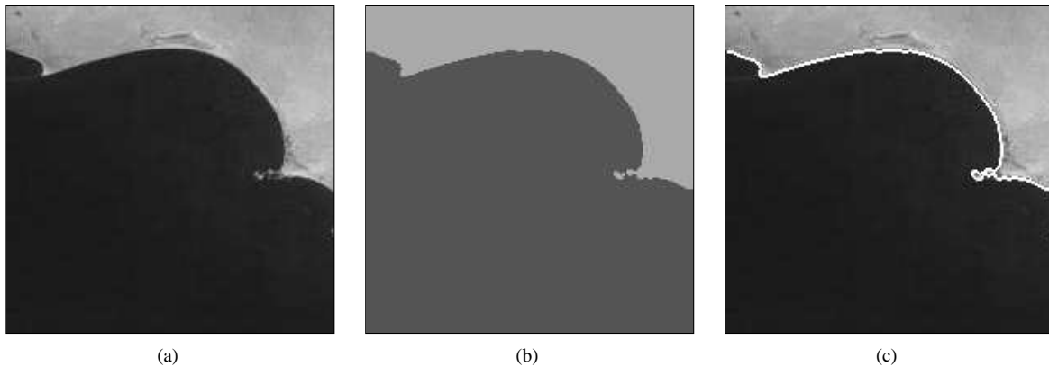
Figura 7. Imagem de Krytar Coast, Aden, Yemen , composta de 200 \times 200 pixels, L = 190 e w = 0.005 . (a) imagem original; (b) classes identificadas; (c) imagem segmentada.
